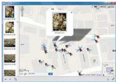
状況によっては室内でもGPSを受信することができたが、測位精度はどうしても落ちてしまうようだ。画像のマップビュー上にポイントされている静止画はすべて同じ建物内で撮影したものになるが、位置情報に誤差が生じている
