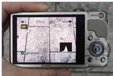
コンパス機能のアイコンは、モニター上でリアルに南北を示す。カメラを水平にすることで、簡易的なコンパスとして使用することも可能だ
