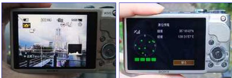
「サイバーショット DSC-HX9V」のGPS機能・コンパス機能をオンにすると、液晶モニター中央上部に、GPSの受信状況を示すアイコンと、方位を示すコンパスが表示される。GPSの詳しい測位情報を確認することも可能だ
